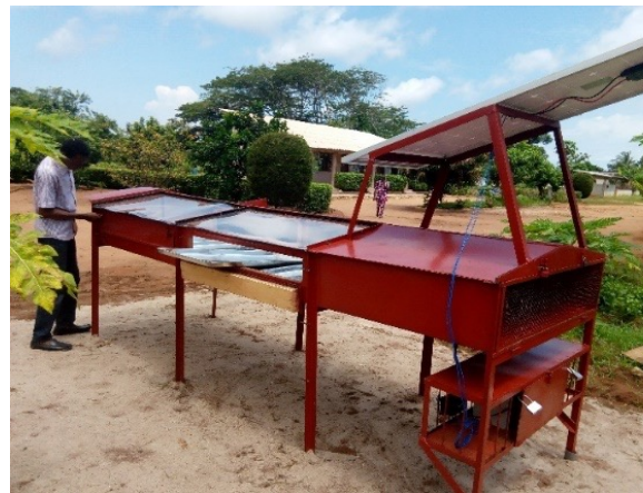
Figure 2 : Photo d'un Séchoir solaire à convection forcée
