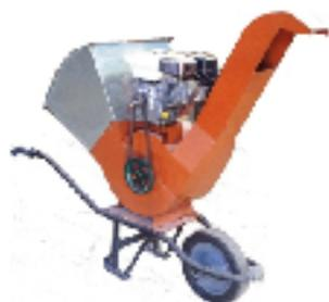
**Type de machine:** Machine agricole semi-automatique facilitant la récolte des graines de courges. Dotée d'une seule roue motrice à brouette pour bien s'adapter aux terrains sans pistes rurales.
