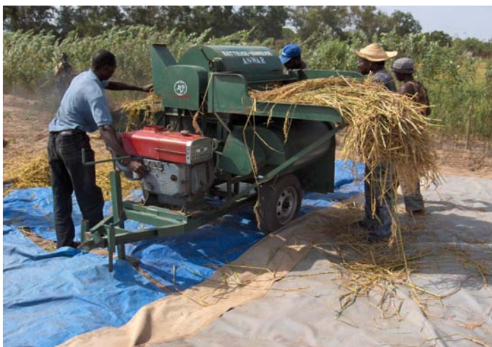
Fig. 8 : Batteuse/nettoyeuse motorisée améliorée (ADRAO/SAED/ISRA, Sénégal)
