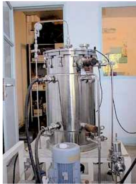
Un bioréacteur ou un fermenteur de cent litres pour la production de biomasse ou de métabolites secondaires.
