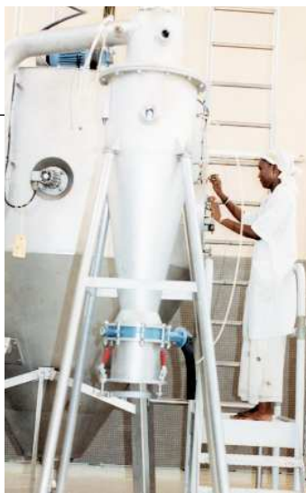
L'unité pilote de séchage par atomisation à l'Institut de technologie alimentaire.
